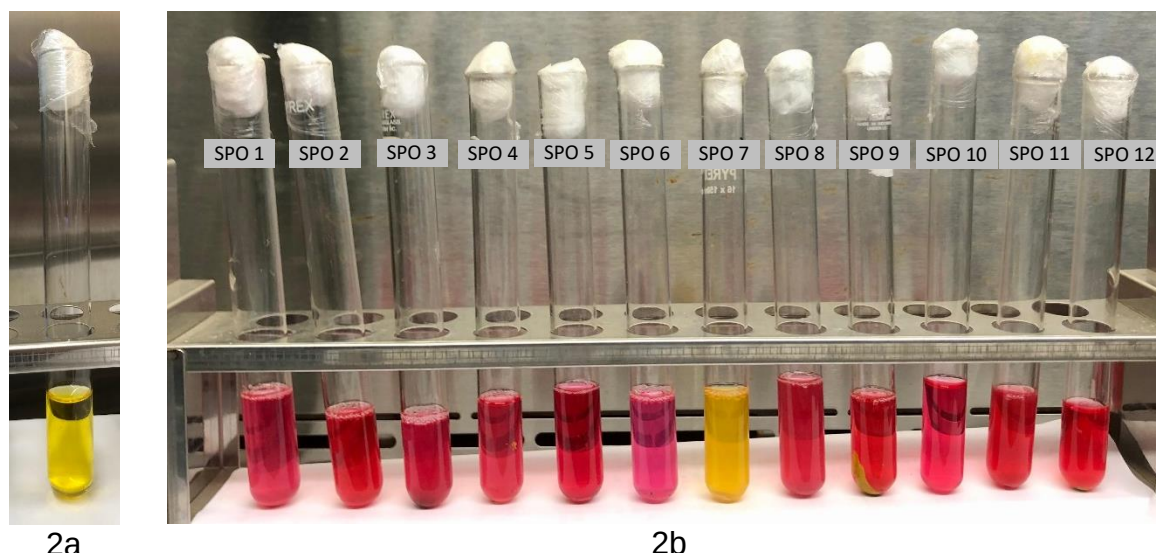
Gambar 2. Skrining aktivitas L-asparaginase dari actinomycetes (a) media M-9 tanpa isolat (b) produksi enzim setelah inkubasi 7 hari
