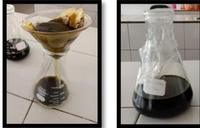
**Gambar 3. Proses Penyaringan.**
