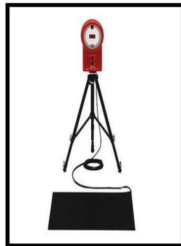
Gambar alat mengukur kekuatan daya ledak otot tungkai (*jump df*)
