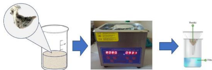
Gambar 1. Proses Ekstraksi Sarang Burung Walet dengan Metode Pemanasan dan Sonikasi
