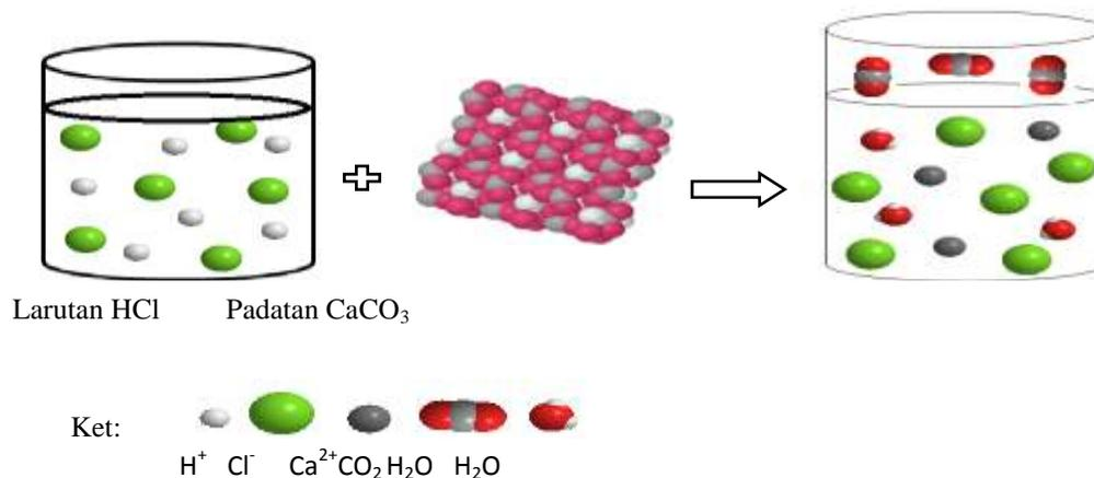
**Gambar 1.** Gambaran mikroskopik antara padatan  $\text{CaCO}_3$  dengan larutan  $\text{HCl}$ : (a) sebelum reaksi; (b) hasil reaksi (molekul pelarut tidak digambarkan). (Gambaran padatan  $\text{CaCO}_3$  dikutip dari McMurry & Fay, 2004: 428)
