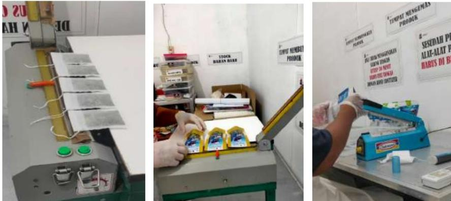
**Gambar 3. Penyegehan Kemasan Menggunakan Hand Impulse Sealer**
