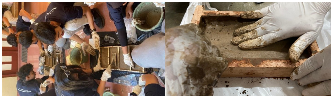
Gambar 4. Pembuatan bata ringan berbahan limbah serat alam Dusun Mriyan Utara
