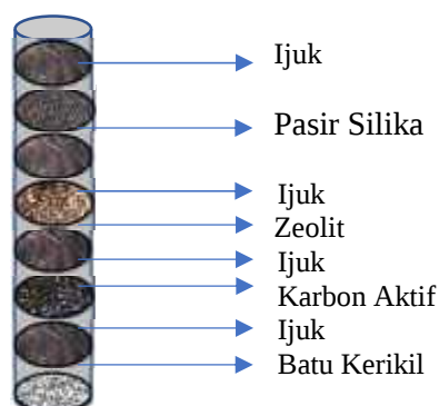
Gambar 2. Skema Tabung Filter Air Sederhana Skala Rumah Tangga dan Bahan-bahan Sebagai Media Filter
